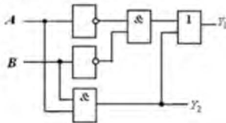
подана следующая комбинация входных параметров:  $A = 1$ ,  $B = 1$ . Определить  $Y_1$  и  $Y_2$
